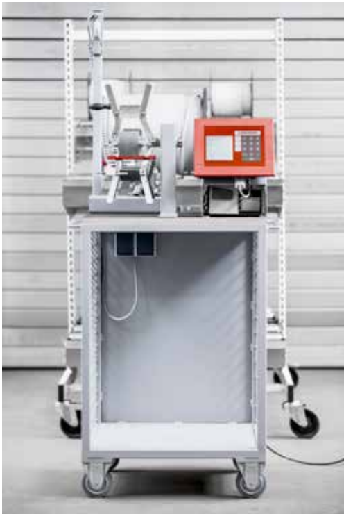
Messwagen mit mit fest installiertem Messgerät, Wickelhaspel und kundenseitig beigestelltem Computer/Drucker.
